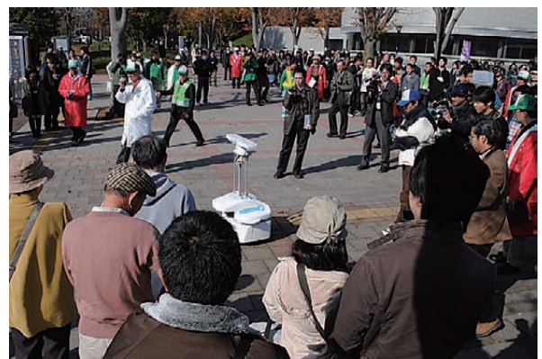
本走行では、スタート順の早いチームはものすごい人だかりのなかを走らなければならない。この人だかりが、ロボットの環境認識に大きな影響を与える。
